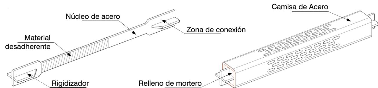
Figura 1. Características generales del disipador Dampo Dual Protect
