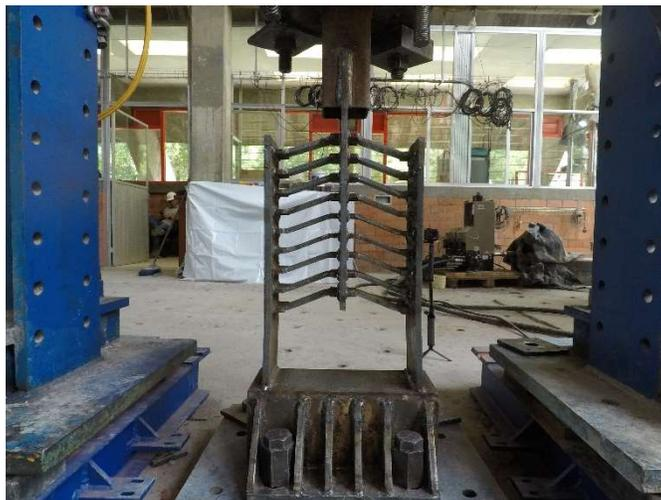
Figura 8. Fotografías del disipador ensayado.
