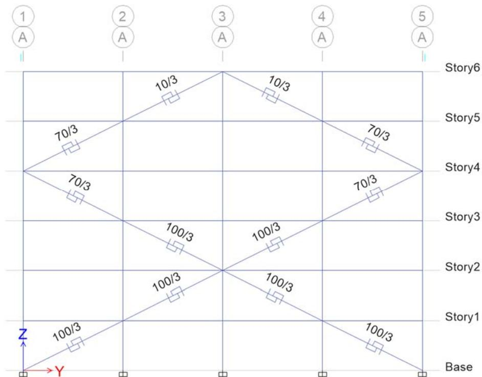
**Figura 50 Elementos equivalentes agregados a la estructura.**
