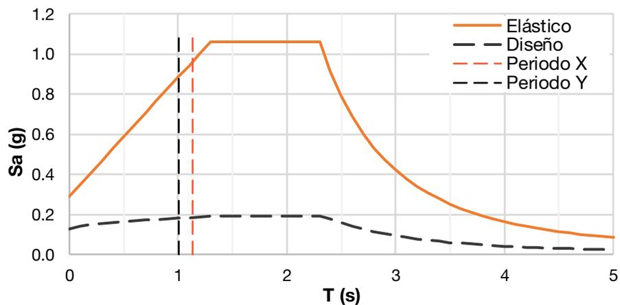
**Figura 44 Espectro elástico y espectro de diseño**
