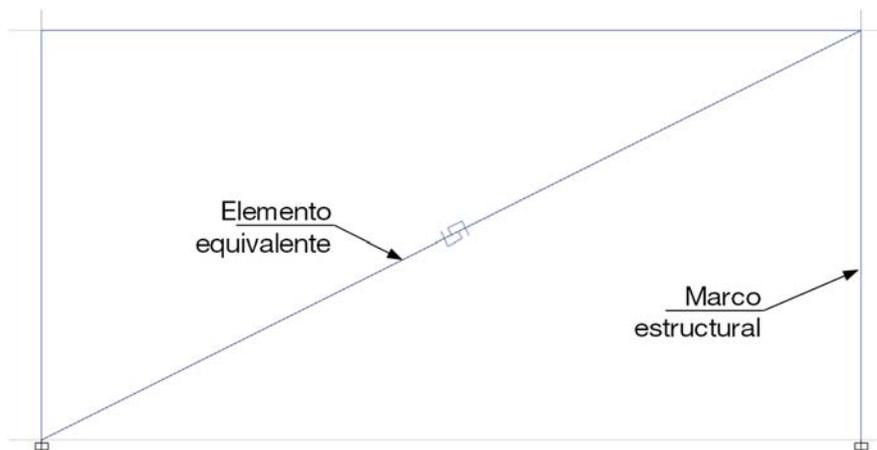
**Figura 21** Elemento equivalente colocado en un marco de la estructura
