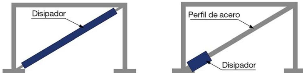
**Figura 2** Esquema de colocación de disipadores
