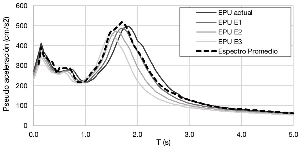
**Figura 70 Comparación entre EPU y el espectro promedio para profundidad intermedia**
