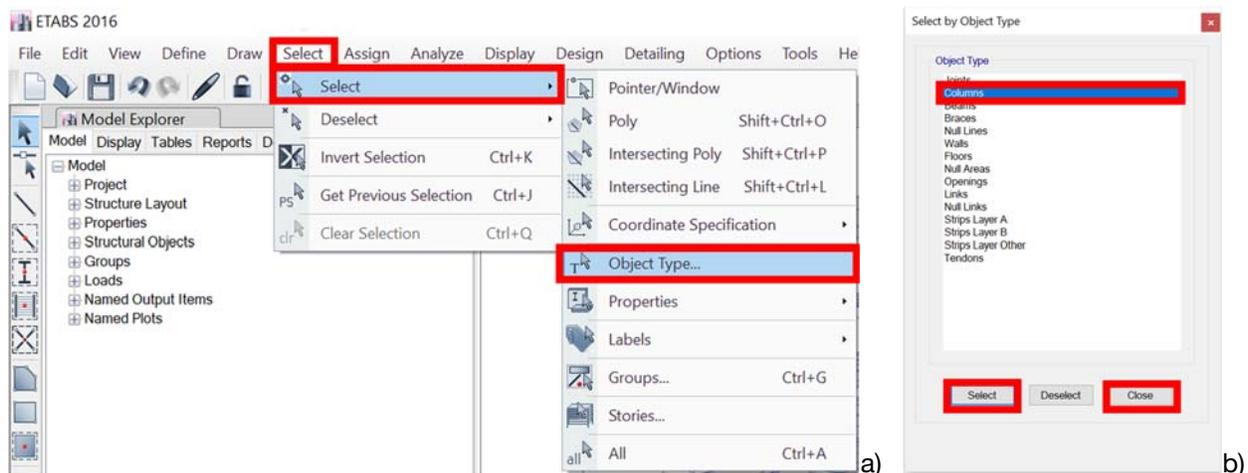
Figura 71 Método de selección de columnas
