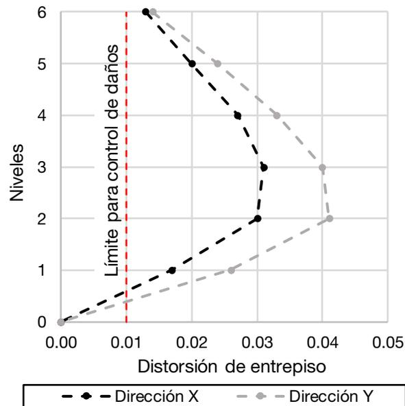
**Figura 46 Distorsiones de entreciso sin disipadores**
