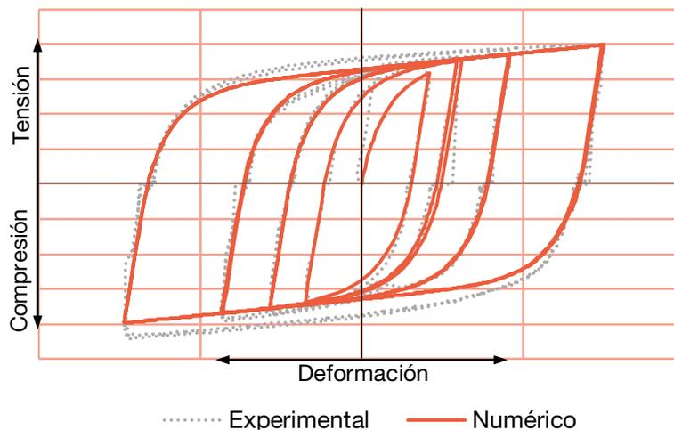
**Figura 42 Curvas experimentales y modelo numérico del disipador DAMPO Dual Protect**
