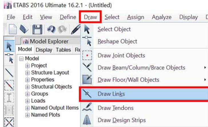
**Figura 20** Menú de dibujo de elementos tipo “link”
