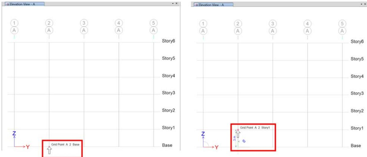
**Figura 39 Dibujo de un elemento barra sobre la retícula**
