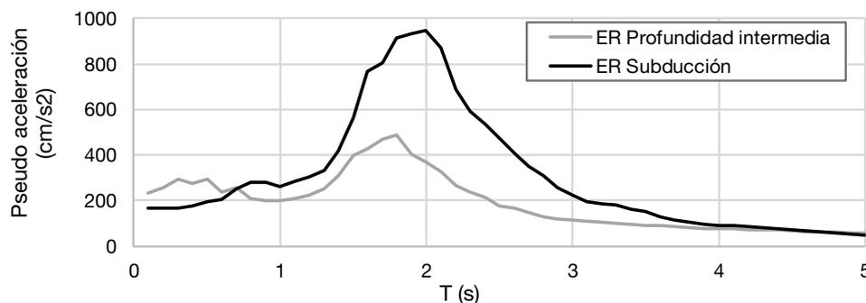
**Figura 60 Espectro de respuesta para sismos de subducción y profundidad intermedia**
