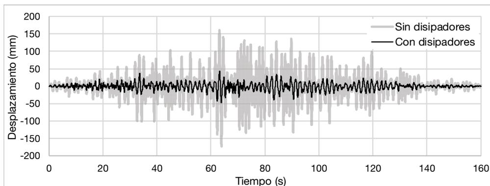
**Figura 112 Respuesta de desplazamiento de la estructura con y sin disipadores.**
