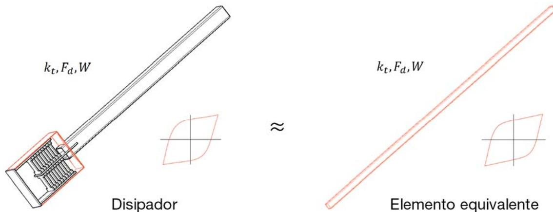
**Figura 14 Idealización del comportamiento de los disipadores**
