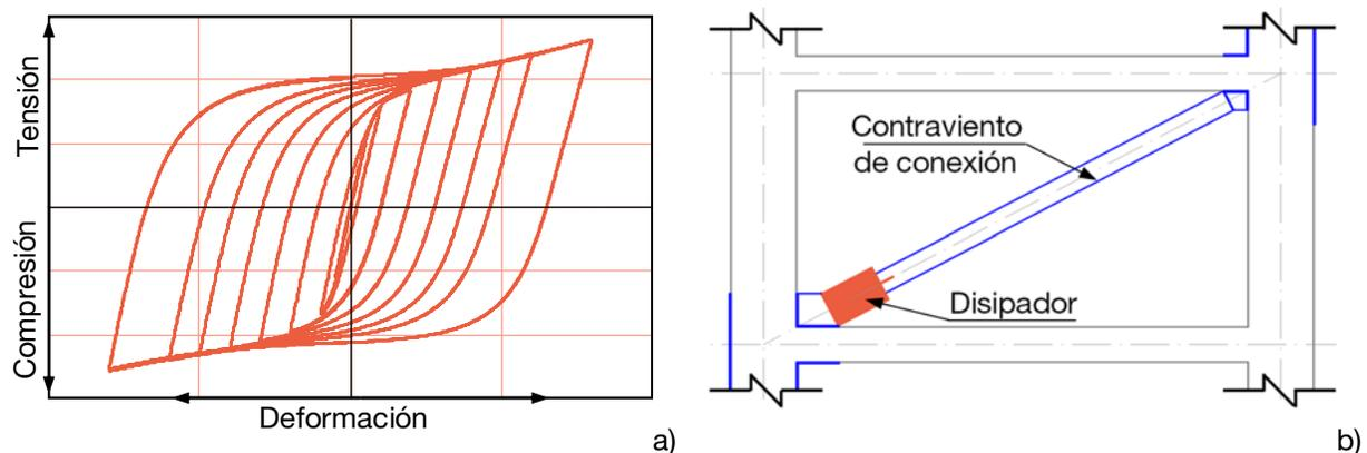
**Figura 7** Curvas de histéresis y esquema de colocación del disipador Dampo 1505
