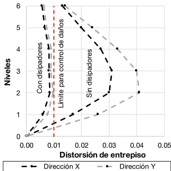
**Figura 53 Distorsiones de entrepiso con disipadores**
