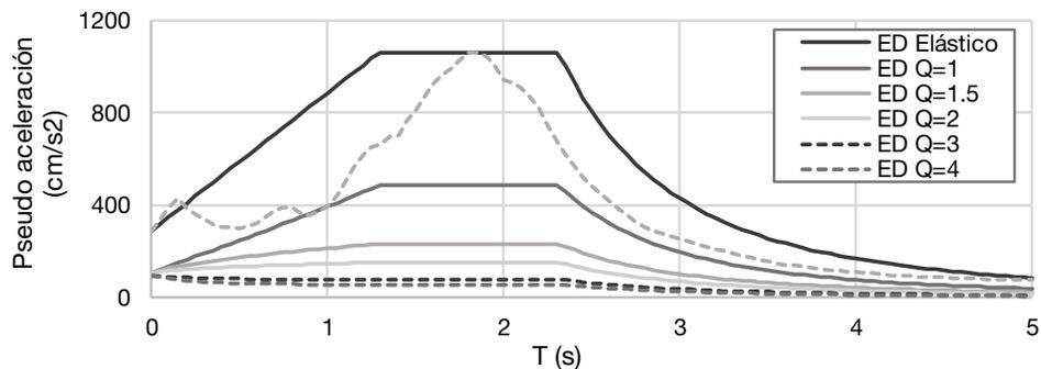
**Figura 57 Espectros de diseño y espectro de peligro uniforme del sitio**
