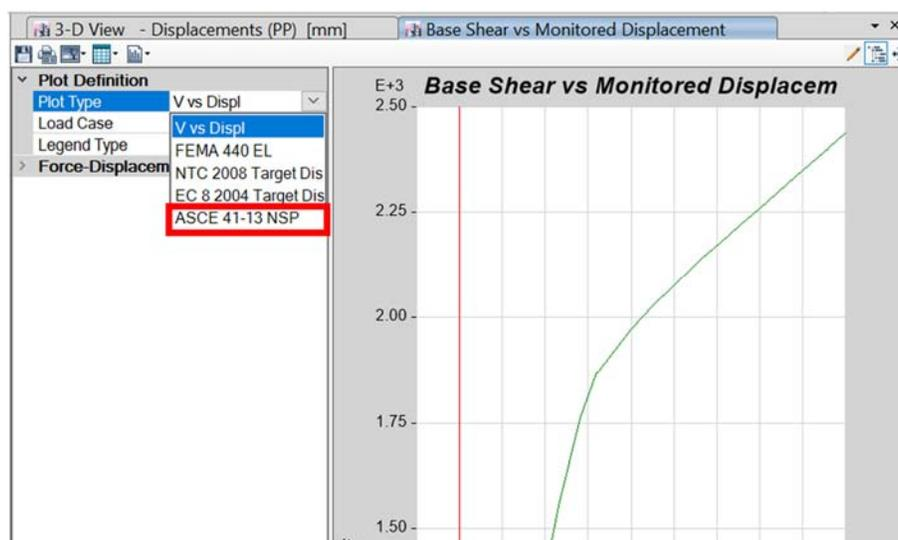
Figura 87 Detalle de la pantalla inicial que muestra la curva de capacidad
