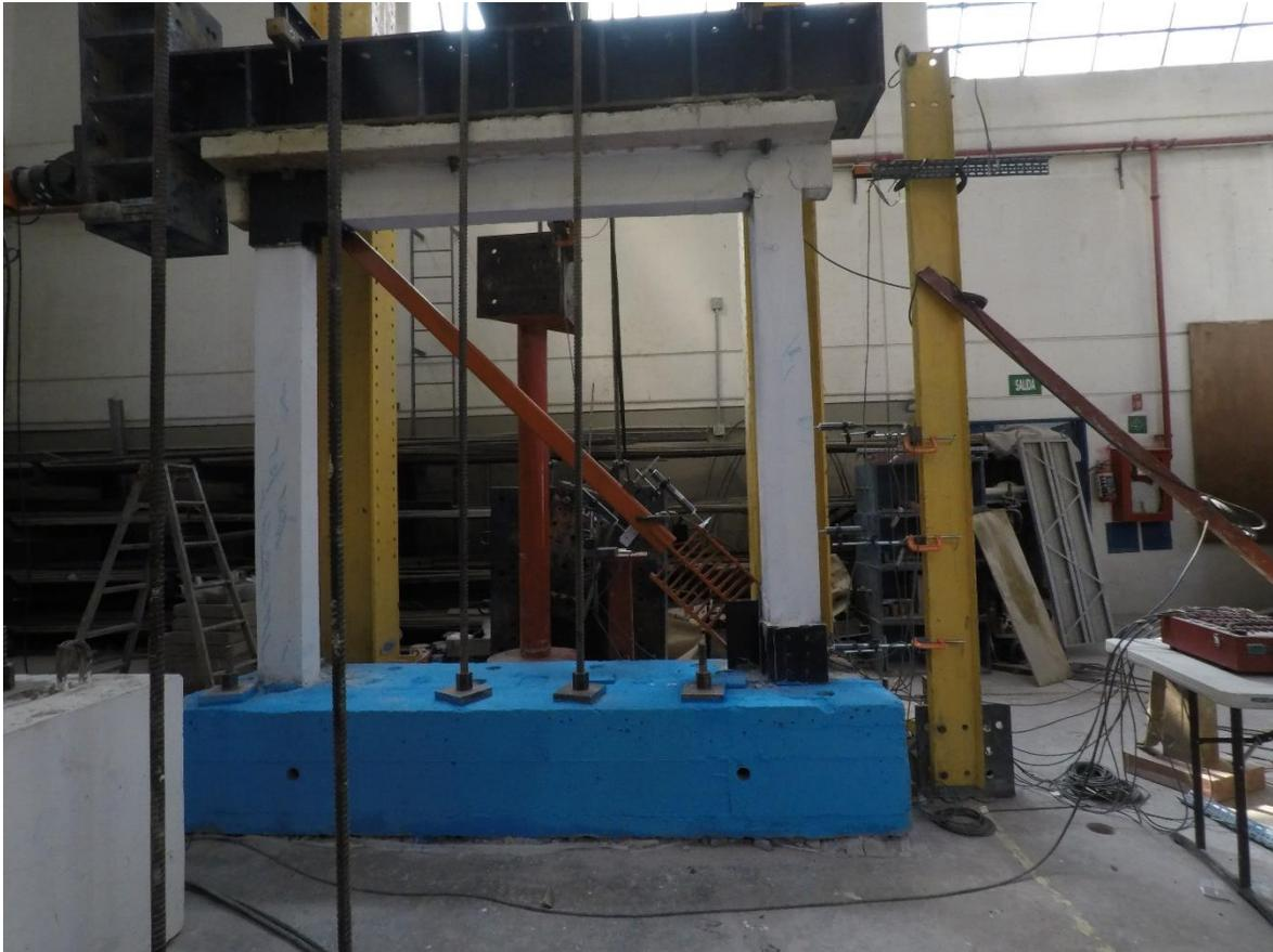
**Figura 8.** Fotografía del marco equipado con dispositivo Dampo 1505.
